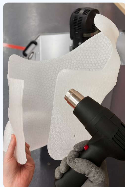
Maintenir le pistolet thermique à 7–10 cm de la surface
